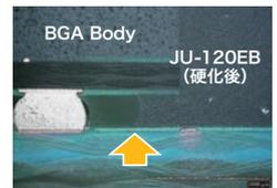
接着剤硬化後の断面写真 (加熱ダレ少なく、BGAボールに接触がないことを実証)
